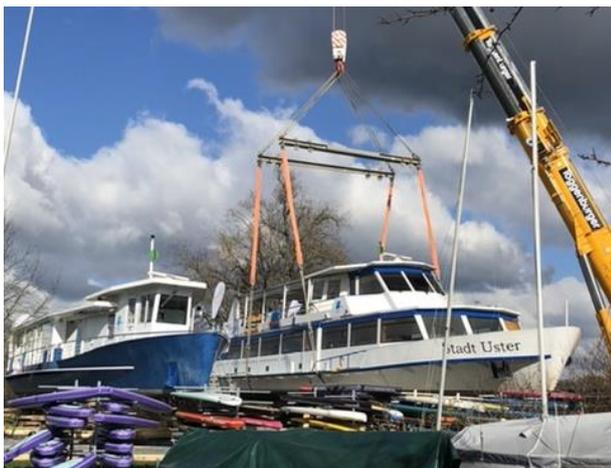
Im Januar 2020 hatte sich gezeigt, dass am MS «STADT USTER» das Bugstrahlruder, das am Bug eine seitliche Fahrt ermöglicht und den Wendekreis verkleinert, defekt ist. Die Reparatur konnte nur auf Trockendock erfolgen.
